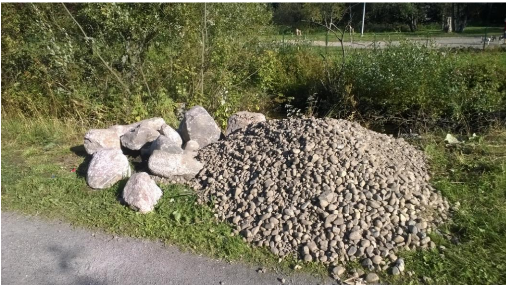
kuva 1: Sora ja isot kivet. Isoimmat kivet ovat pisimmältä särmältään n. 500 mm pitkiä. Vastaava materiaalmäärä odotti kunnostajia toisenkin kosken niskalla.
